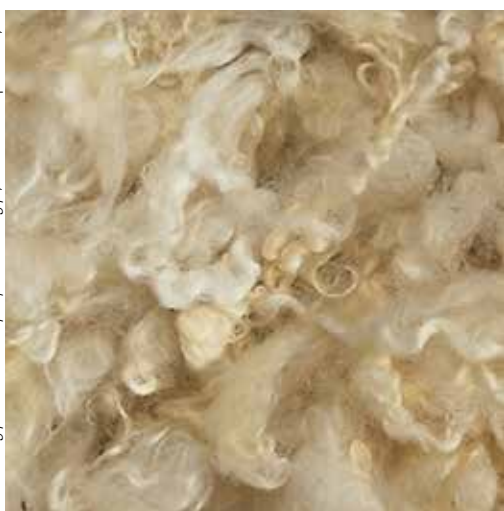
izolacija iz ovčje volne ponovna uporaba: 60-80% tip uporabe: ponovna uporaba prihranek \text{CO}_2 : 1,8 \text{kg/m}^2
