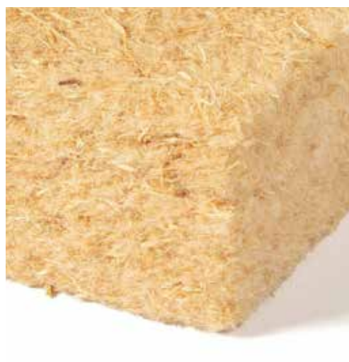
izolacija iz lesenih vlaken ponovna uporaba: 90% tip uporabe: manjvrednostno recikliranje prihranek \text{CO}_2 : 2,3 \text{kg/m}^2
